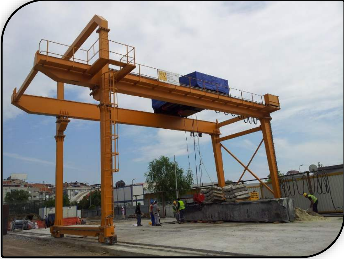
25+5 Ton Kapasiteli Portal Vinç
