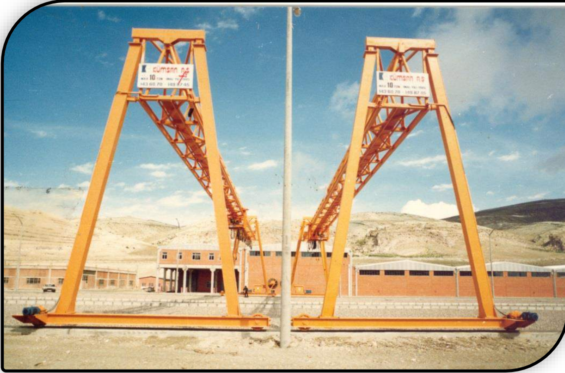
10 Ton Kapasiteli Portal Vinç
