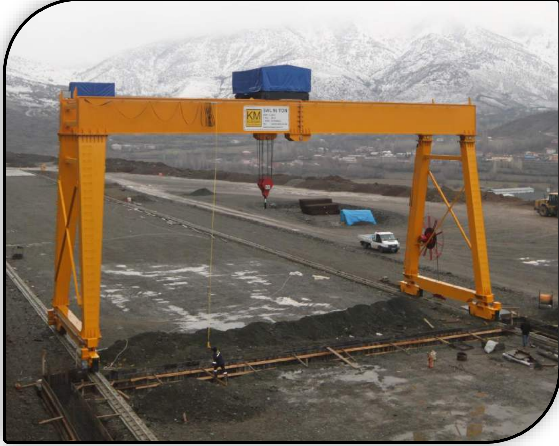
95 Ton Kapasiteli Portal Vinç
